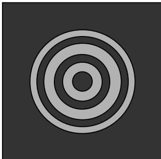
Figur 3. Sternenmuster eines kollimierten Teleskops.
