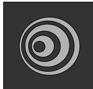
Figur 4. Sternenmuster eines nicht kollimierten Teleskops.
